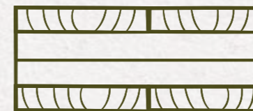
Grundsätzlicher Aufbau eines 4-lagigen Brettsperrholzes
