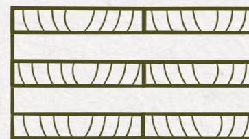
Grundsätzlicher Aufbau eines 5-lagigen Brettsperrholzes
